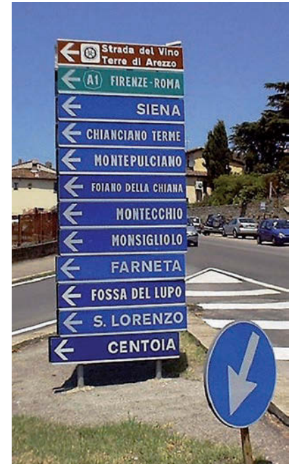
Fig. 4 Esempio di segnaletica verticale sovrabbondante
