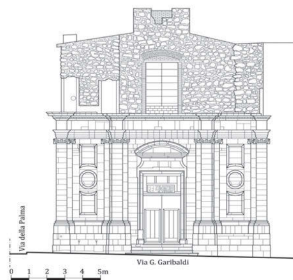
Fig. 1 Rilievo del prospetto principale
