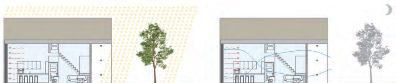
Figura 4 – In estate durante il giorno la massa inerziale assorbe i carichi termici interni, durante la notte la ventilazione naturale raffredda la massa portando fuori il calore accumulato
