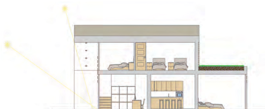
Figura 1 – Strategie passive: disposizione dell'edificio studiata per consentire il soleggiamento degli ambienti in inverno e da evitarlo in estate
