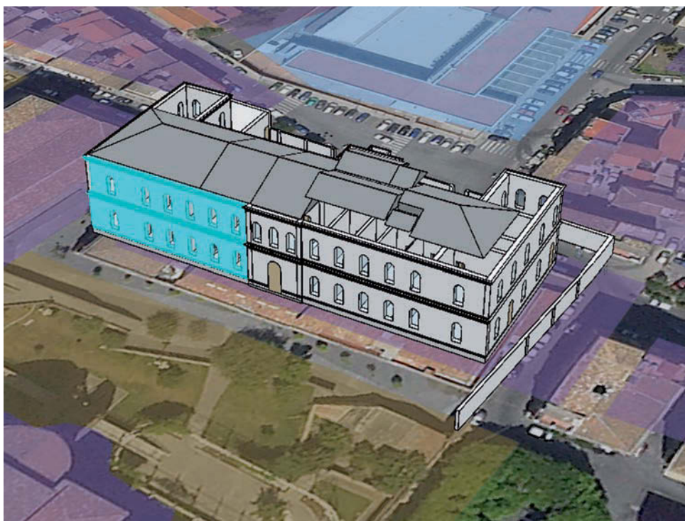
Figura 4: Modello BIM di Palazzo Ingrassia, posto all'interno del contesto urbano di pertinenza.
